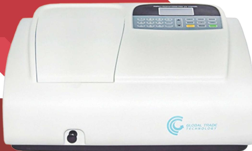
O Espectrofotômetro Digital GTA-97 é a escolha ideal para uma ampla gama de análises laboratoriais. Com um design intuitivo e uma tela LCD retroiluminada, este equipamento facilita a programação e a criação de curvas, permitindo salvar até 9 pontos de calibração. Ele conta com ajustes automáticos de zero e 100% T ao iniciar, garantindo medições precisas desde o primeiro uso.
